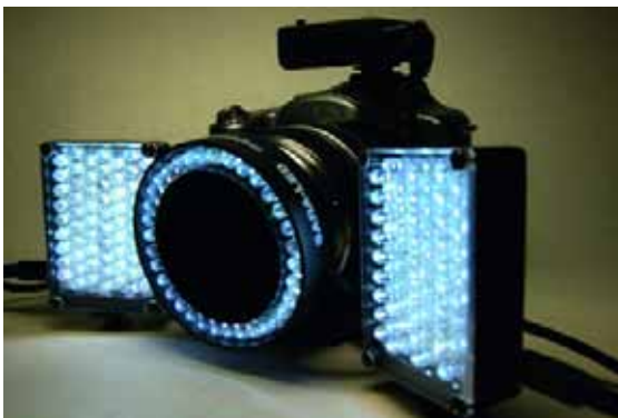
Das SARA-LED-LateralLight kombiniert mit Ringlicht
