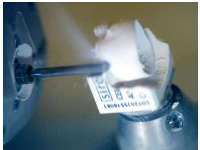
Abb. 7: Trockenfräsen einer monolithischen Zirkonoxid-Molarenkrone aus dem vorgesinterten Zustand (Cerec Zirconia) in der inLab MC XL Fräs- und Schleifeinheit
