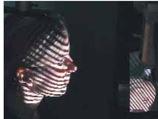
Abb. 3: Streifenprojektion: vertikale Projektion
