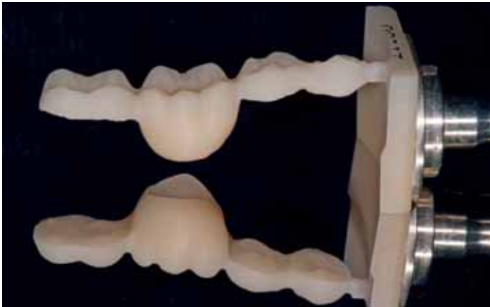
Abb. 3c: CAD/CAM-Fertigung: Implantatkrone und Onlayschalen aus hochvernetztem Polymermaterial nach der CAD/CAM-Fertigung
