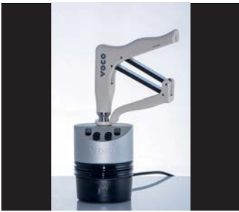
Abb.14 Das thermoviskose Komposit wird in einem Kompositofen (Caps Warmer) auf 68 °C erwärmt.
