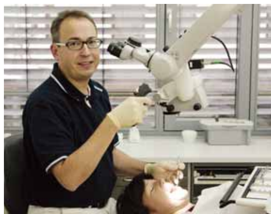
Abb. 6: Zeiss OPMI Pro Ergo Dentalmikroskop mit Stativ an der Centrosäule, motorischem Vergrößerungszoom und Brennweitensteuerung, Xenonbeleuchtung und Videokamera
