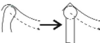
Abb. 3: Imitation des Kiefergelenks durch den Arcon-Artikulator
