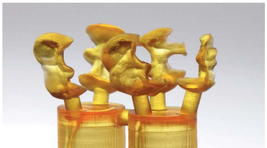
Abb. 21 und 22: 3-D-Druck der Teilkronen mit dem Dekema trixprint 3-D-Drucker
