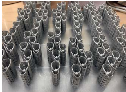
Abb. 10: Bauplattform nach dem additiven Bauprozess der Klammern
