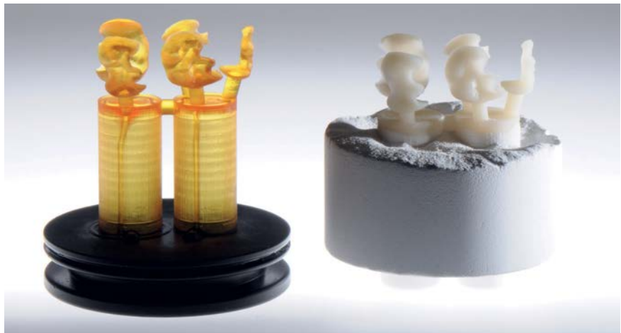
Abb. 25: Gegenüberstellung der 3-D-gedruckten und der gepressten Teilkronen
