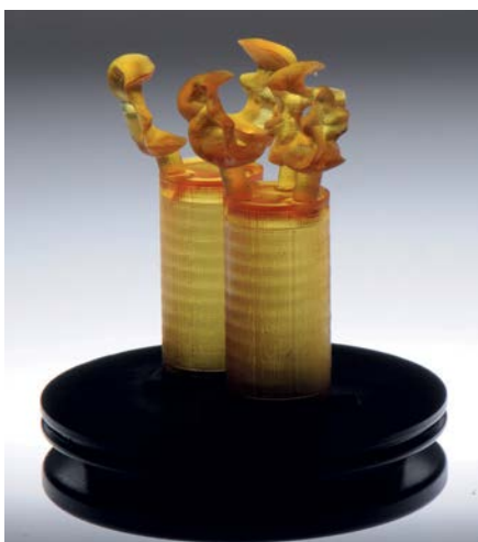
Abb. 21 und 22: 3-D-Druck der Teilkronen mit dem Dekema trixprint 3-D-Drucker
