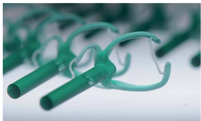
Abb. 6: 3-D-gedruckte Klammern aus rückstandslos verbrennbarem Kunststoff für die Lost-wax-Technik
