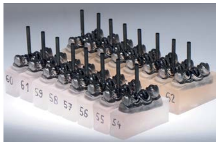
Abb. 11: Abzugsmodelle mit 16 lasergesinter-ten Klammern
