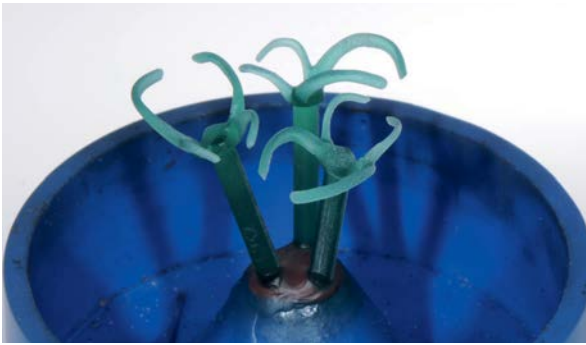
Abb. 7 und 8: Einbetten und Gießen der 3-D-gedruckten Klammern
